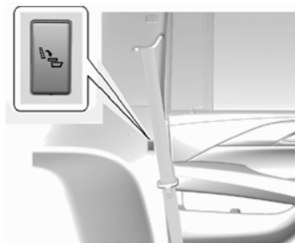
Кнопка электропривода складывания со стороны водителя
