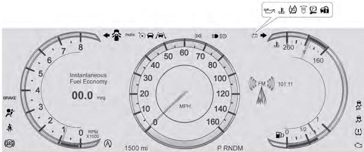
Показана комбинация приборов с британской системой единиц измерения (базовая комплектация); комбинация приборов с метрической системой – аналогично
