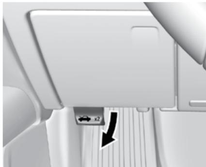
1. Потяните рукоятку открывания капота. Она расположена слева под приборной панелью между дверью и рулевым колесом.
