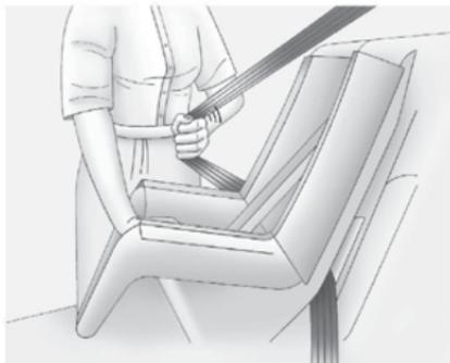
5. Вытяните плечевой ремень безопасности из возвратного механизма на всю длину для активации функции блокировки. После блокировки возвратного механизма ремень может натягиваться, но вытянуть его из возвратного механизма уже будет невозможно.
