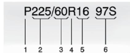
**(1) Шина для легкового автомобиля (P-metric).** Версия метрической классификации типоразмера шин, принятая в Соединенных Штатах Америки. Буква P в начале обозначения размера шины означает, что данная шина предназначена для легковых автомобилей и разработана в соответствии со стандартами Американской ассоциации изготовителей шин и колес (U.S. Tire and Rim Association).
