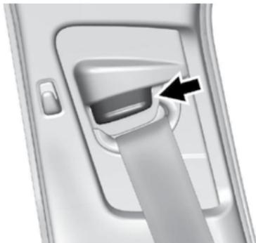
Нажмите кнопку фиксатора и переместите верхнее крепление ремня безопасности в желаемое положение. Регулятор можно переместить вверх, потянув его подвижную часть вверх по направляющим. После установки верхнего крепления в желаемое положение проверьте надежность его фиксации, попытавшись переместить его вниз, не нажимая кнопку фиксатора.
