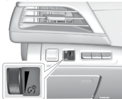
Яркость подсветки органов управления, расположенных на приборной панели и рулевом колесе, может регулироваться.
