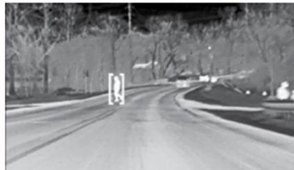
Если включена система FPB, то при обнаружении слишком быстрого приближения автомобиля к пешеходу система ночного видения выводит на проекционный дисплей предупреждающий индикатор красного цвета. Кроме того, подаются звуковые предупреждения или импульсы вибрации на подушку сиденья водителя (при соответствующей комплектации). См. *Система автоматического торможения при обнаружении пешеходов во время движения вперед (FPB)* → 252.
