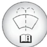
Откройте крышку с данным символом. Долейте жидкость омывателя ветрового стекла так, чтобы заполнить весь бачок. Расположение бачка см. в разделе *Моторный отсек* → 271.
