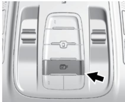
При соответствующей комплектации нажмите кнопку F для открывания или закрывания передней солнцезащитной шторы вентиляционного люка.
