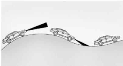
Не используйте систему АСС при движении по холмистой местности или при буксировке прицепа. При буксировке прицепа см. *Буксировка прицепа* → 265. При движении по холмистой местности система АСС не будет обнаруживать автомобили, движущиеся перед вашим автомобилем. При движении по холмистой местности чаще, чем при движении по равнинной местности, приходится ускоряться и тормозить, особенно при буксировке прицепа. При нажатии педали тормоза система круиз-контроля отключается.
