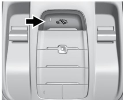
При выключенном зажигании нажмите кнопку
