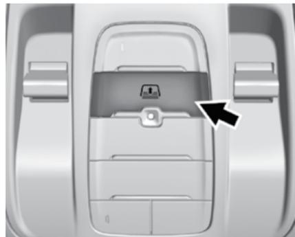
При соответствующей комплектации нажмите и отпустите переключатель. Шторка закроет заднее стекло. Чтобы опустить шторку, снова нажмите и отпустите переключатель. Шторка полностью сложится и откроет заднее стекло.
