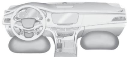
Модуль коленной подушки безопасности водителя находится под рулевой колонкой. Модуль коленной подушки безопасности переднего пассажира находится под перчаточным ящиком.
