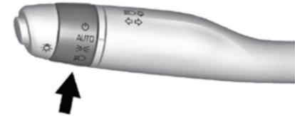
Переключатель наружного освещения находится на рычаге переключателя указателей поворота.
