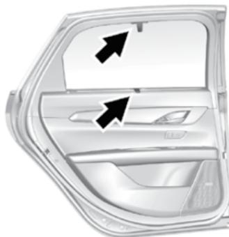
При соответствующей комплектации, чтобы поднять шторку, потяните ручку шторки вверх и присоедините ее к держателю, расположенному в верхней части проема окна.
