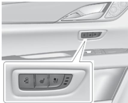
При соответствующей комплектации нажмите кнопку
