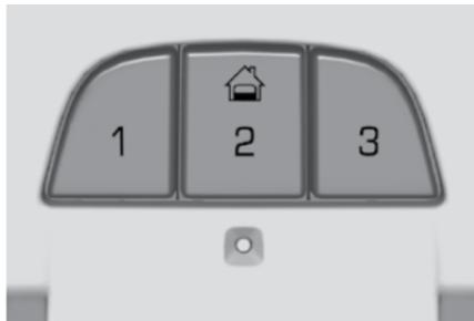
На автомобилях, оборудованных универсальной системой дистанционного управления, соответствующие кнопки расположены на потолочной консоли.
