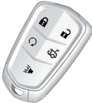
**🔒** нажмите данную кнопку, чтобы запелереть все двери. При запираии замков в качестве сигнала обратной связи могут мигать указатели поворота и/или срабатывать звуковой сигнал. См. *Пользовательские настройки* → 158.
