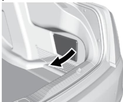
Крышка блока предохранителей, расположенного в багажнике, находится на боковой панели облицовки багажного отделения со стороны переднего пассажира.
