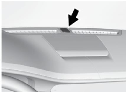
С помощью датчика интенсивности солнечного света, расположенного на верхней части приборной панели ближе к основанию ветрового стекла, определяется интенсивность солнечного излучения.
