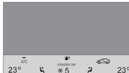
Данный экран кратковременно отображается при нажатии кнопок управления системой климат-контроля на центральной консоли.
