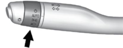
Переключатель приборов наружного освещения находится на рычаге переключателя указателей поворота.
