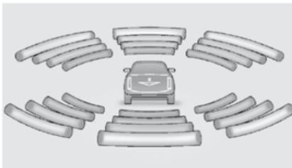
На дисплее систем помощи при парковке на комбинации приборов (при соответствующей комплектации) отображаются блоки, показывающие расстояние до объекта, а также информация системы помощи при парковке, касающаяся расположения препятствий. По мере приближения к препятствию количество подсвеченных блоков увеличивается и цвет блоков изменяется с желтого на оранжевый и красный.
