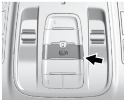
При соответствующей комплектации нажмите кнопку
