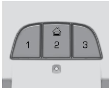
При соответствующей комплектации эта система позволяет запрограммировать до трех пультов дистанционного управления, используемых для управления такими устройствами, как, например, привод гаражных ворот, охранные системы и различные домашние автоматические системы.
