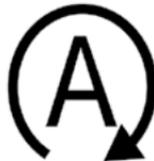
Данный индикатор загорается, когда двигатель находится в режиме автоматической остановки.
