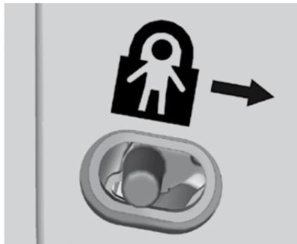
При соответствующей комплектации выключатели блокировки задних дверей находятся на внутренних кромках задних дверей. Для использования выключателя блокировки замка:
