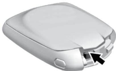
2. Отделите друг от друга две половины корпуса пульта при помощи плоского инструмента, вставив его в нижнюю центральную часть корпуса пульта. Не вставляйте его в паз для ключа.
