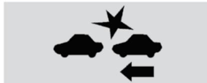
При активированной системе ACC внимание водителя может привлекаться, если система ACC не способна интенсивно затормозить автомобиль из-за очень большой скорости сближения автомобилей.
