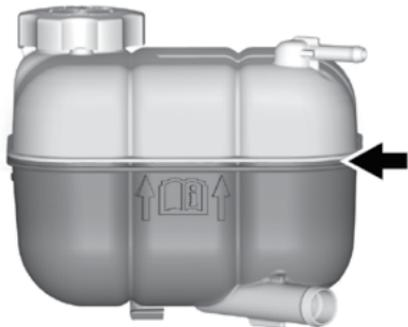
Расширительный бачок автомобилей с двигателем 2,0 л L4 и 3,0 л V6
