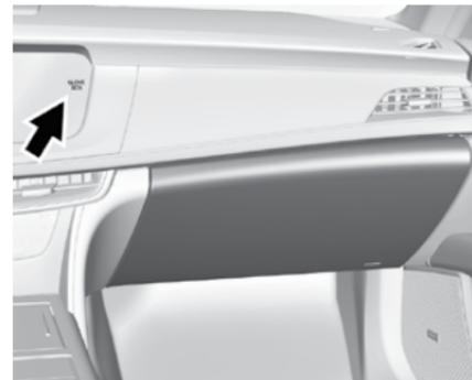
Чтобы открыть перчаточный ящик, коснитесь кнопки GLOVE BOX (перчаточный ящик). Перчаточный ящик закрывается вручную.
