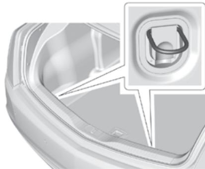
Проушины можно использовать для крепления мелких предметов и багажной сетки. См. *Сетка для крепления мелкого багажа* → 117 (при соответствующей комплектации).
