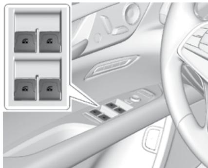
Питание к электроприводам стеклоподъемников подается в режиме ACC/ACCESSORY кнопки запуска, а также в режиме задержки отключения питания дополнительного оборудования (RAP). См. *Режим задержки отключения питания дополнительного электрооборудования (RAP)* → 213.
