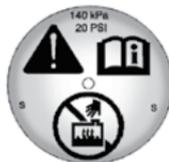
1. Дайте остыть компонентам системы охлаждения, включая расширительный бачок системы охлаждения и верхний шланг радиатора, затем снимите крышку расширительного бачка. Медленно поверните крышку против часовой стрелки приблизительно на четверть оборота. Если будет слышно шипение, подождите, пока оно не прекратится. Это позволит сбросить избыточное давление.
