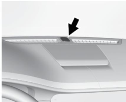
С помощью датчика интенсивности солнечного света, расположенного на верхней части приборной панели ближе к основанию ветрового стекла, определяется интенсивность солнечного излучения.
