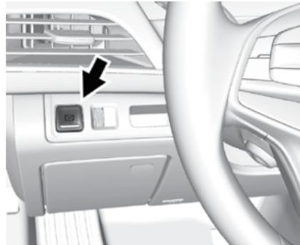
Данный автомобиль оснащен стояночным тормозом с электроприводом (EPB). Стояночный тормоз с электроприводом может быть задействован всегда, даже при выключенном зажигании. Во избежание разрядки аккумуляторной батареи не пользуйтесь стояночным тормозом при выключенном двигателе слишком часто.
