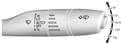
При включенном зажигании или в режиме ACC/ ACCESSORY кнопки запуска двигателя переместите рычаг выбора режимов очистителя/омывателя ветрового стекла вверх или вниз, чтобы выбрать частоту движения щеток стеклоочистителя.
