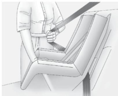
4. Вытяните плечевой ремень безопасности из возвратного механизма на всю длину для активации функции блокировки. После блокировки возвратного механизма ремень может натягиваться, но вытянуть его из возвратного механизма уже будет невозможно.
