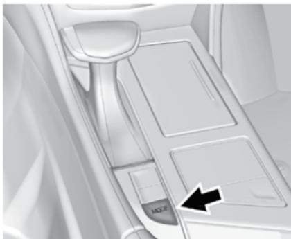
Нажмите кнопку MODE (режим), чтобы отобразить меню режимов на дисплее комбинации приборов. При первом нажатии кнопки на комбинации приборов отображается текущий режим. При последующих нажатиях происходит последовательное переключение между доступными режимами. При изменении условий движения выбирайте соответствующий режим. Доступны следующие режимы:
