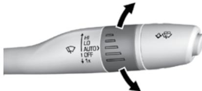
**AUTO (автоматический режим):** используйте данную настройку для включения прерывистого режима работы щеток, когда функция Rainsense деактивирована, или для включения системы Rainsense, когда функция Rainsense активирована. Для активации прерывистого режима работы щеток переместите рычаг выбора режимов очистителя/омывателя ветрового стекла в положение AUTO. Затем поверните кольцевой регулятор на рычаге вверх для выбора более коротких интервалов или вниз – для более длинных интервалов.
