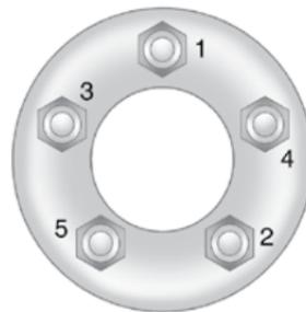
16. Надежно затяните колесные гайки в диагональной последовательности, как указано на рисунке.
