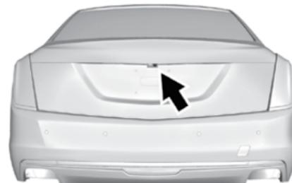
Камера, изображение с которой выводится на дисплей внутреннего зеркала заднего вида (RCM), расположена над площадкой заднего государственного номерного знака рядом с камерой заднего обзора (RVC).
