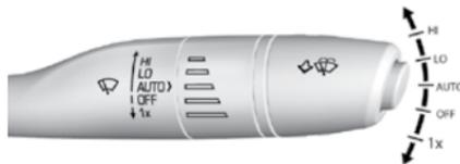
При включенном зажигании или при положении ACC/ ACCESSORY кнопки запуска двигателя переместите рычаг выбора режимов очистителя/омывателя ветрового стекла вверх или вниз, чтобы выбрать частоту движения щеток стеклоочистителя.
