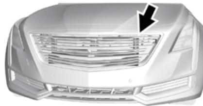
Автомобиль может быть оснащен аэродинамической заслонкой, предназначенной для повышения топливной экономично-
