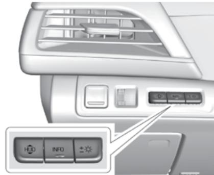
Кнопки управления проекционным дисплеем находятся на приборной панели слева от рулевого колеса.
